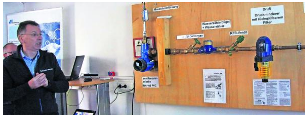
Manfred Walter zeigt das von Wassermeister Thomas Schreiber angefertigte Modell eines Hausanschlusses.
